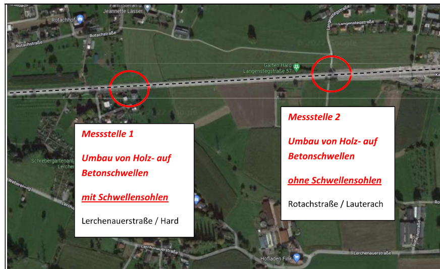
Abbildung 3. Messstellen auf der Strecke Lustenau-Lauterach mit und ohne Schwellensohlen
